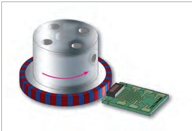
Bild 1: Typische Messanordnung eines FIXPITCH® Sensors zur inkrementellen Winkelmessung
