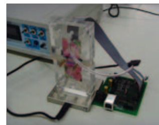
Funktionsmuster des Disposables und der Geräteelektronik
