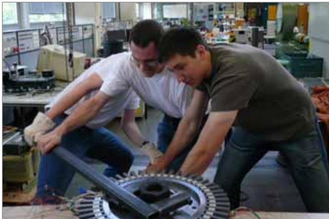
Bild 2: Zusammenbau der Transversalflossmaschine an der FH Gelsenkirchen (Quelle: FH Gelsenkirchen)
