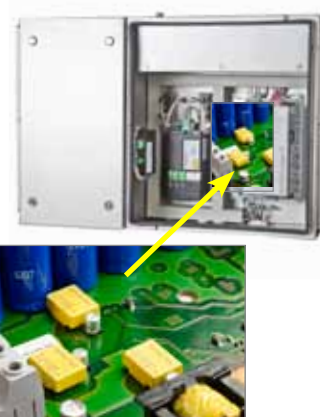
CDS4000 Stromsensoren sind im geschützten Gehäuse der PITCHmaster II+ Achsbox der Firma Moog zur Drehzahlregelung des Rotors verbaut (Quelle: Moog Unna GmbH).
