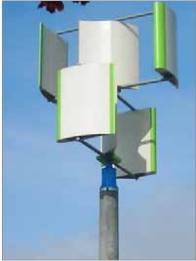
Bild 1: Kleinwindkraftanlage in H-Darrieus-Rotor Ausführung
