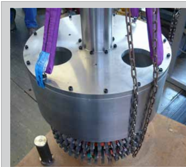
Bild 3: Montage des als Außenläufer ausgeführten Rotors (Quelle: FH Gelsenkirchen)
