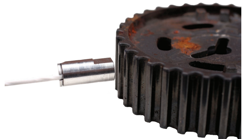
Bild 2: Der SSA2302 AMR-Drehzahlsensor nutzt Zahnräder als Maßverkörperung (Bildquelle: Sensitec GmbH).
